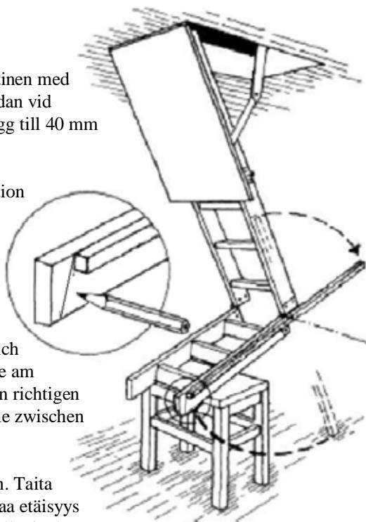
(D) **Holtztreppe.** Legen Sie den Messstab auf den untersten Treppenabschnitt und mit dem gezeichneten Strich am oberen Ende. Markieren Sie die Länge der Treppenseite am unteren Ende des Messstabes. Addieren Sie 40 mm, um den richtigen Winkel zum Boden zu erhalten, und zeichnen Sie eine Linie zwischen den Markierungen.
