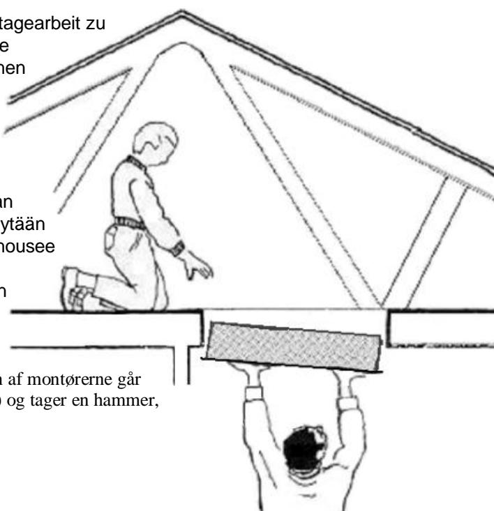
(DK) Man bør være 2 personer for at lette monteringsarbejdet og for at undgå ulykker. En af montørerne går op på loftet på en stige (ikke loftrappens stige) og tager en hammer, skruemaskine, skruer, kiler og målebånd med.
